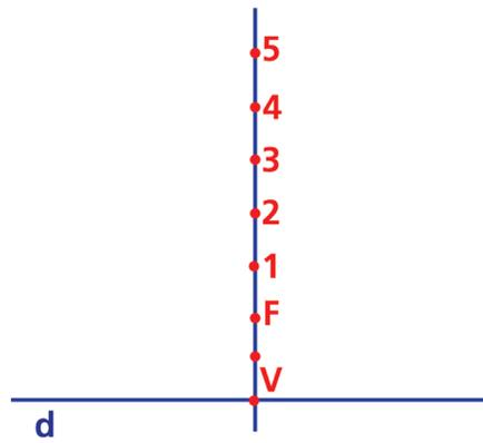
**4º passo:** Trace retas perpendiculares ao eixo S pelos pontos F, 1, 2, 3, 4 e 5.
