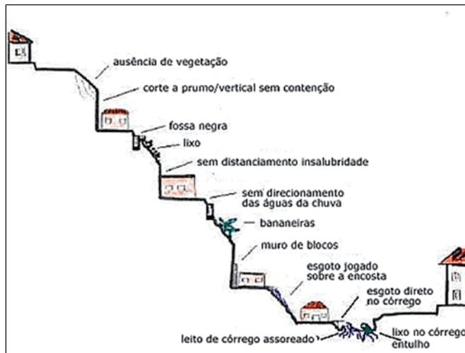
Figura 11. Esquema representativo da ocupação antrópica irregular em encostas e os desastres decorrentes.
