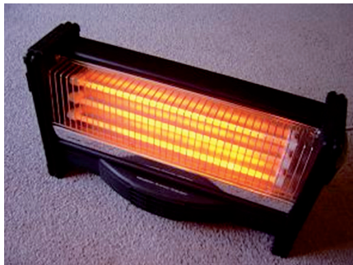
Figura 5: Quando uma corrente elétrica passa por um resistor, os elétrons colidem com os átomos do condutor. Esse atrito gera calor.
