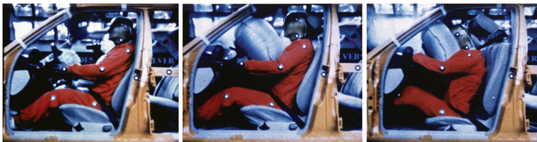
Figura 2: Os airbags são inflados em apenas 4 centésimos de segundo, após a colisão do automóvel, protegendo assim o motorista e o passageiro de lesões mais graves.
