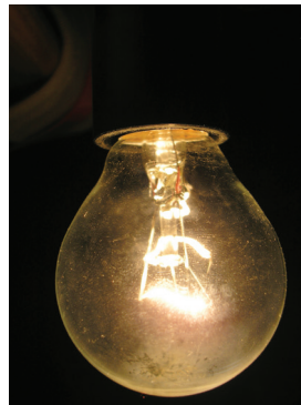
Figura 4.2: Transformação de energia elétrica em energia luminosa e térmica
