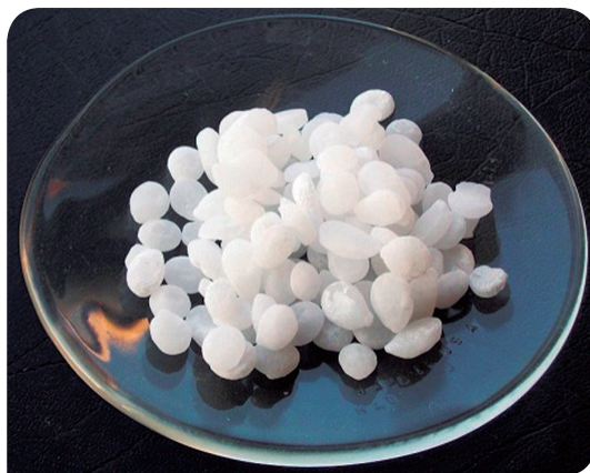
Figura 11: O hidróxido de sódio é uma importante matéria-prima industrial, utilizada na fabricação do papel, tecidos, biodiesel, entre outras, obtida por meio da eletrólise de uma solução aquosa de cloreto de sódio. Além dele, são obtidos o gás cloro (usado no tratamento de água e de outros produtos como o PVC), o ácido clorídrico (utilizado para limpar e galvanizar metais e no refino de uma grande variedade de produtos) e o hipoclorito de sódio (usado como desinfetante e alvejante, sendo o princípio ativo da água sanitária).
