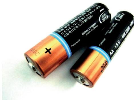
Figura 8: Outro exemplo de gerador é a pilha que consegue estabelecer um potencial elétrico de 1,5V.
